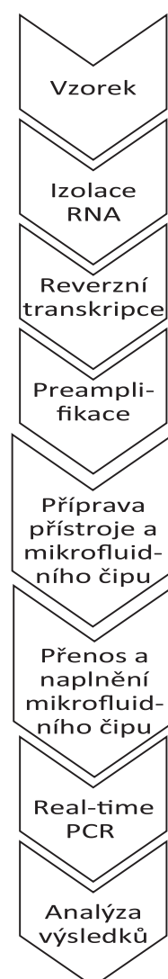
Obr. 3 – Schéma analýzy genové exprese pomocí přístroje Biomark X
